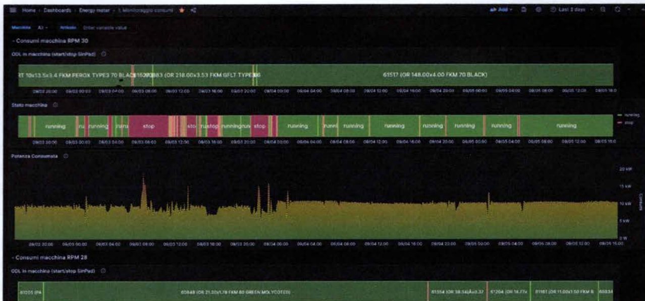
Figura 4: Schermata del Software di monitoraggio dei consumi energetici (Energy Dashboarding) ECOPLUG che consente il monitoraggio da remoto ed in tempo reale, nonché la raccolta automatizzata dei consumi elettrici registrati a bordo dei singoli macchinari interconnessi. L'immagine mostra l'integrazione delle informazioni raccolte dal Software MES (Manufacturing Execution System) SINLOG
